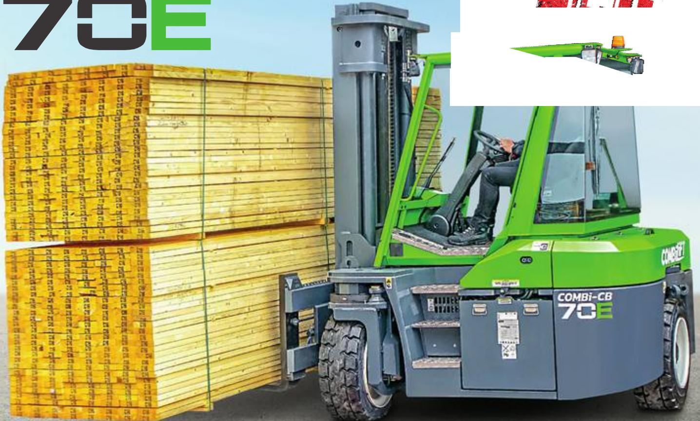
Der neue **COMBI-CB 70 E** ist der kürzeste Gegengewichtsstapler mit einer Tragfähigkeit von 7t auf dem Markt und damit ideal für lange und große Lasten, auch in unwegsamem Gelände.
